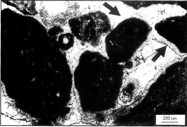
Şekil 6: Kabataş dokusunu gösterir fotomikrograf (Kabataş litofasiyesi). Tane kenarları üzerinde iyi gelişmiş birincil eş boylu çimentonun varlığı (oklarla gösterilmiş) sıg ve yüksek enerjili bir çökel ortamını işaret eder.
